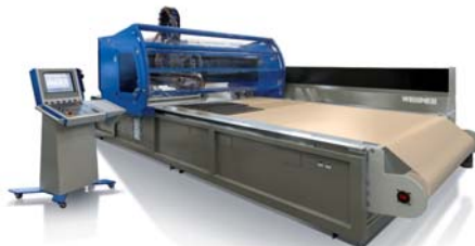
Mitfahrende Haube und Teiletransport durch Papiervorschub
